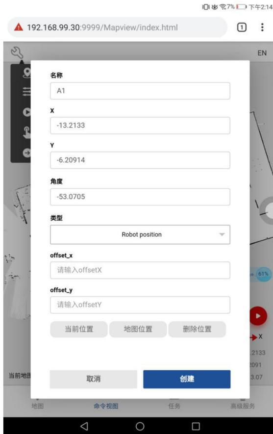
如图所示：创建 A1 点，使用当前位置，可以自动获取智能车的位置，自动填充表格数据，点击创建，如下图所示：小车的位置出现 A1 的位置点，位置点有编辑和前往两个功能。
